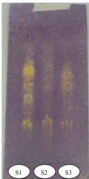
Figure 1: Profil chromatographique du screening de l'activité anti-oxydante des extraits S1, S2, S3 développant n-BuOH/ AcOH/ H 2 O (6/ 1,5/ 2,5; v/ v/v)
