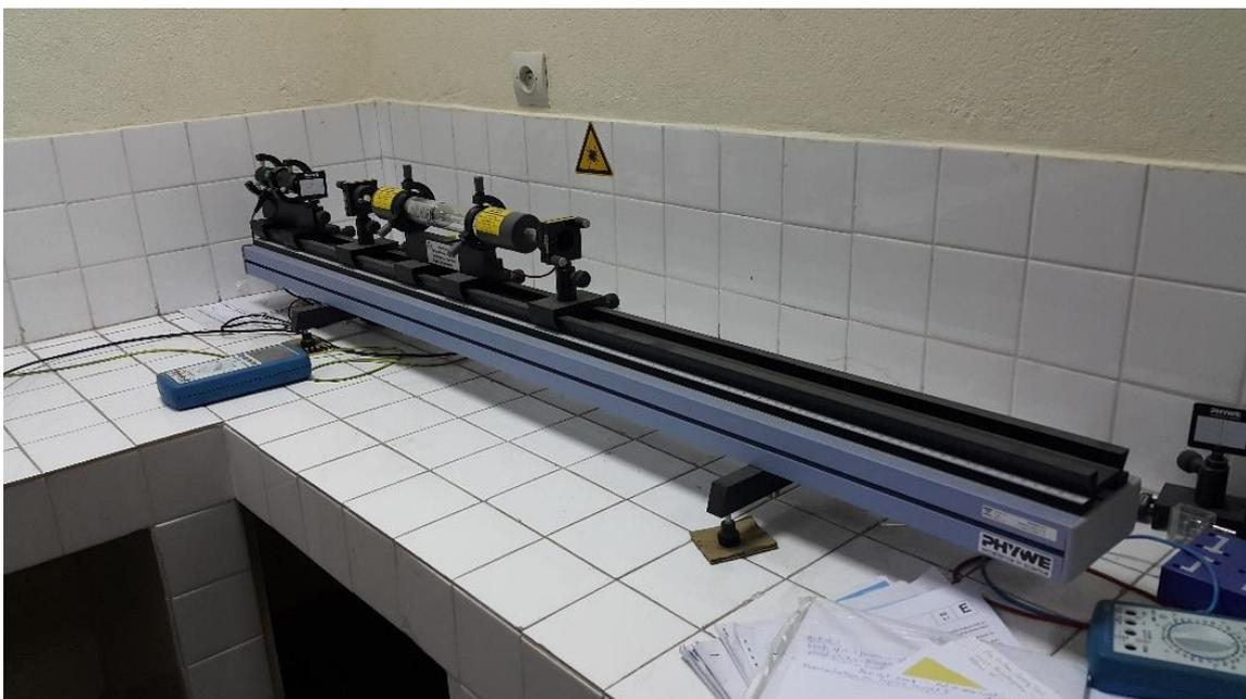
Dispositif de Travaux Pratiques sur le LASER
